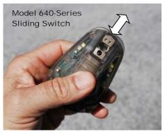
Main Switch: 0=Off, Functions 1 & 2 · Nose Switch/Plug: ▲=Mode A, ▼=Mode B
